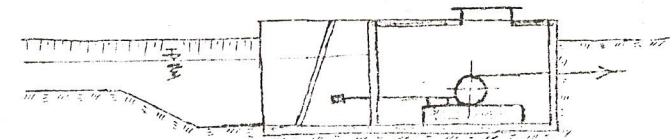
FIG 8. STATIE DE POMPARE CU CUVA SUBTERANA USCATA , AVANCAMERA , FARA SUPRASTRUCTURA
